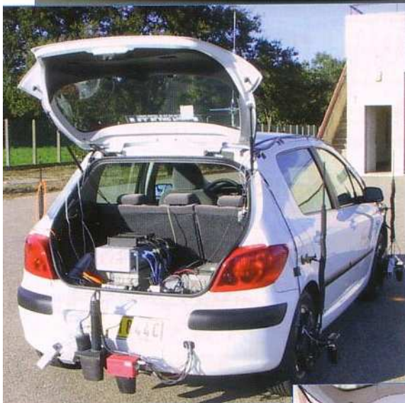
Figure 12 : Vue générale de l'ensemble de l'instrumentation embarquée de la 307.
