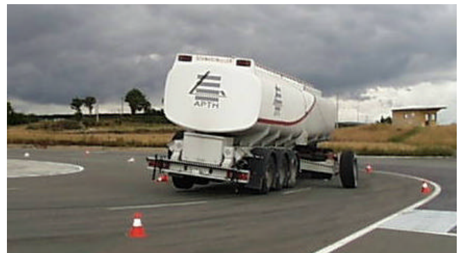
Fig. 12 : Soulèvement des roues intérieures en virage stabilisé
